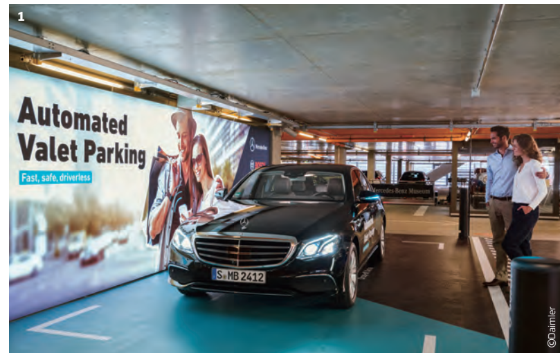
1 메르세데스-벤츠 박물관의 다층 주차장이라는 한정된 영역 안에서는 이미 레벨 4 완전 자율주행이 시작했다. 2 이 무인 주차는 차량과 각종 센서 및 지능형 관제 시스템 간의 연결과 소통을 통해 이뤄진다.
