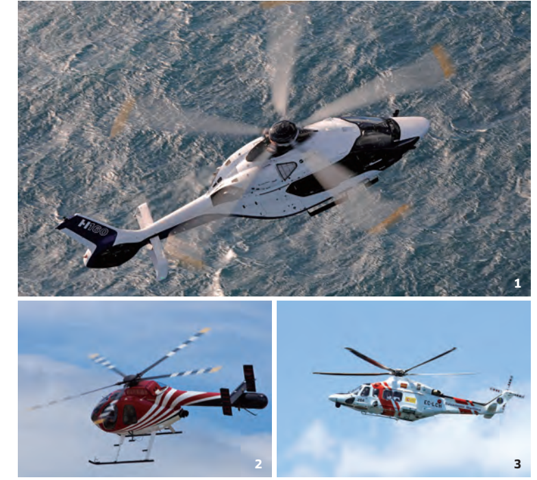
1 테일 로터를 프레임 안에 설치한 페네스트론 방식의 H160. 2 테일 로터가 없는 노타 방식의 MD 520N. 3 일반적인 노출형 테일 로터를 장착한 AW139.
